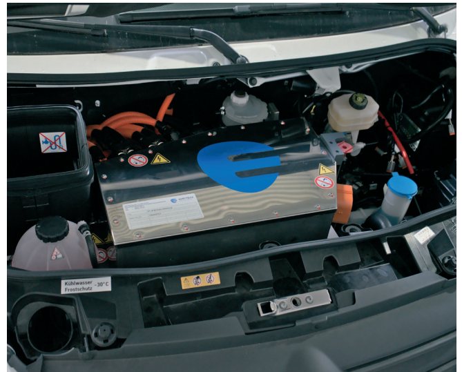
Der leistungsstarke Synchronmotor ist in das Batterieversorgungssystem inkl. Intelligenterem Batteriemanagement integriert. Dieses überwacht, regelt und schützt die Stromversorgung des gesamten Fahrzeugs. (Bild: WAS)
