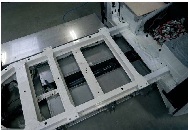
Der Einbau der Batterien auf Fahrgestellhöhe sorgt für eine sehr gute Straßenlage. (Bild: WAS)
