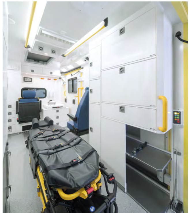
Multifunktionaler Schrank mit verschiedenen Stauräumen, ausgeführt mit Klappen oder Türen. Zugänglich von innen und außen.
