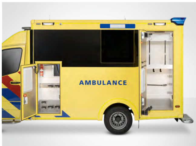
Die tief ausgeführten Seitenfächer auf der linken Fahrzeugseite bieten viel Stauraum für medizinische Hilfsmittel, Immobilisierungsmaterial und Tragestuhl.
