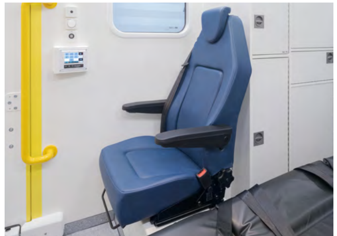
Komfortabler Sitz mit integriertem Dreipunktgurt, zwei Armlehnen, verstellbarer Rückenlehne und Kopfstütze.
