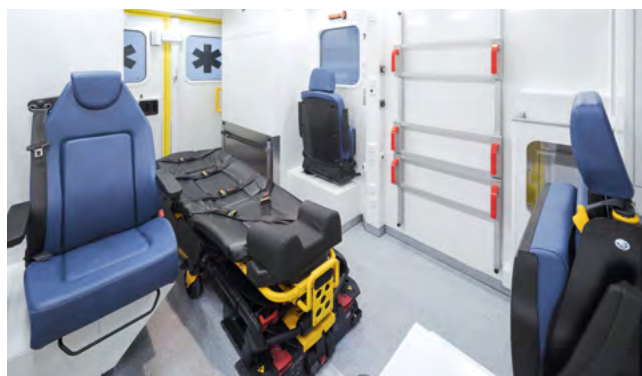
Multifunktionaler Patientenraum mit drei Begleitersitzen, rechts, links und am Kopfende des Patienten positioniert.
