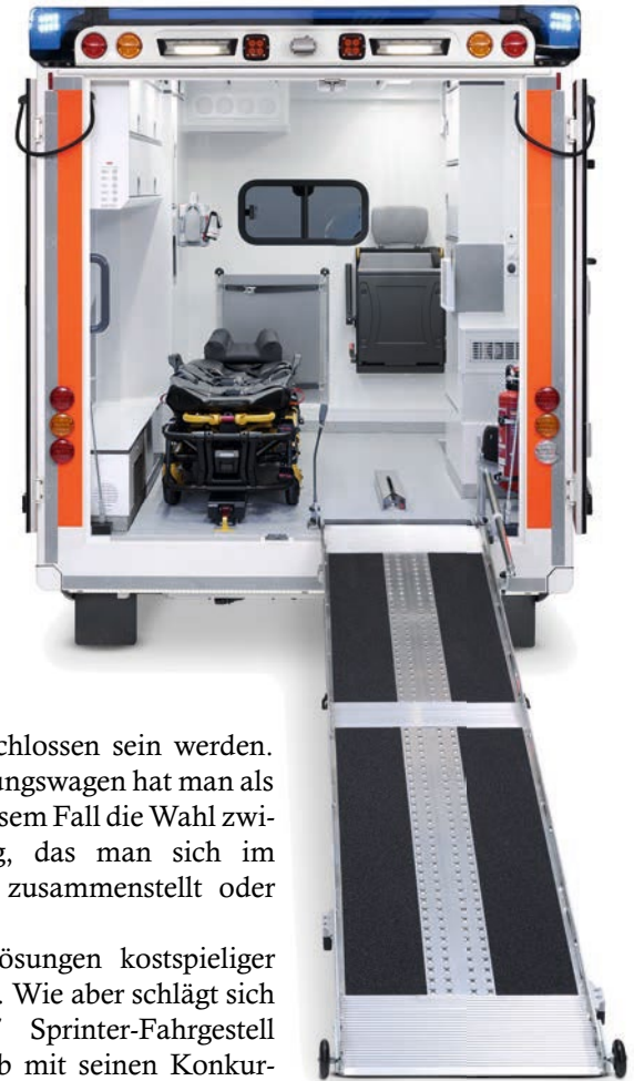
Heckseitige Rampe zum ergonomischen Be- und Entladen des Patiententragestuhls.
