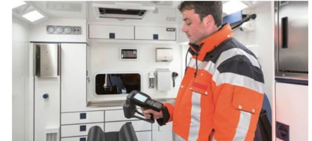
Die Ausrüstungskontrolle mit RFID, **WAS Smart Check**, ermöglicht Rettern in kurzer Zeit, die Ausrüstung fehlerfrei für Einsätze vorzubereiten. Verbrauchsgüter und medizinische Geräte werden mit einem RFID-Chip versehen und können mit dem eigenständigen System in wenigen Minuten überprüft werden.
