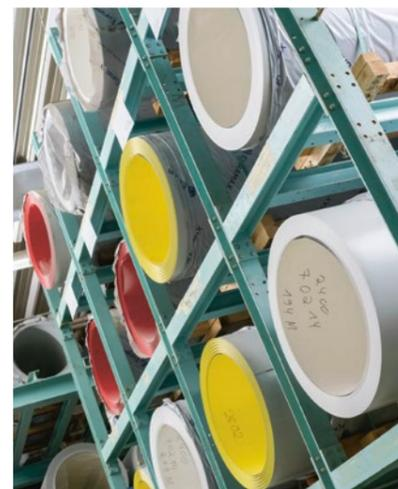
Die Außenverkleidung in verschiedenen Farben lagert auf großen Rollen, den Aluminium Coils, in der Werkshalle.
