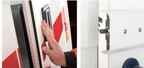
Die elektromechanische Zuziehhilfe **WAS Door Assist** schließt Türen sicher ohne Knallen und Überdruck im Wagen zu erzeugen.
