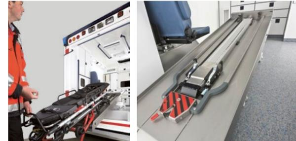
**WAS Multi-Load Assist** ist eine elektromechanische Einzugshilfe für alle gängigen Fahrtragensysteme. Mit dem elektrischen Einzug wird die Fahrtrage mit dem Patienten ruck- und erschütterungsfrei auf den Ambulanztisch gezogen.
