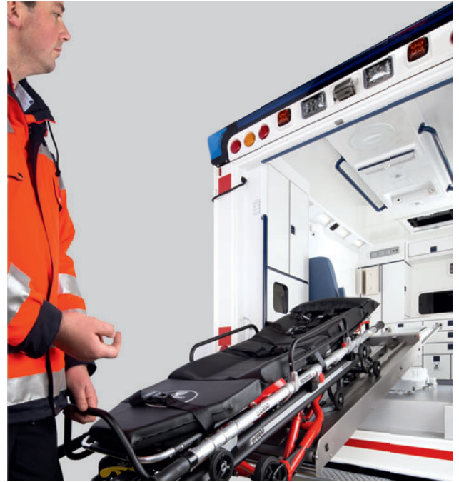
Nach dem Koppeln der Trage mit dem Einzugssystem wird das WAS Multi-Load Assist aktiviert.
