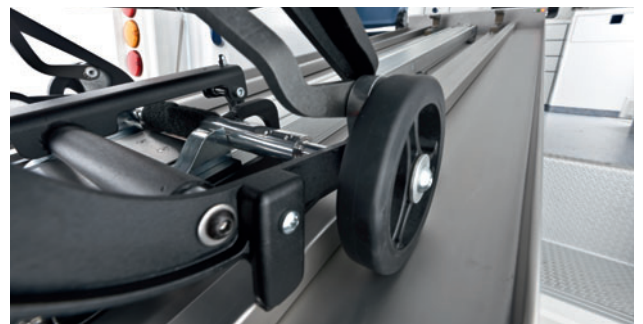
Der Fahrtragenneutrale Einzugsschlitten arretiert sicher.
