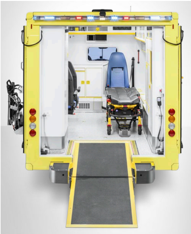
Einfach zu bedienende Kassettenrampe mit 450 kg Traglast. Eine elektrisch betriebene Seilwinde erleichtert das Beladen.
