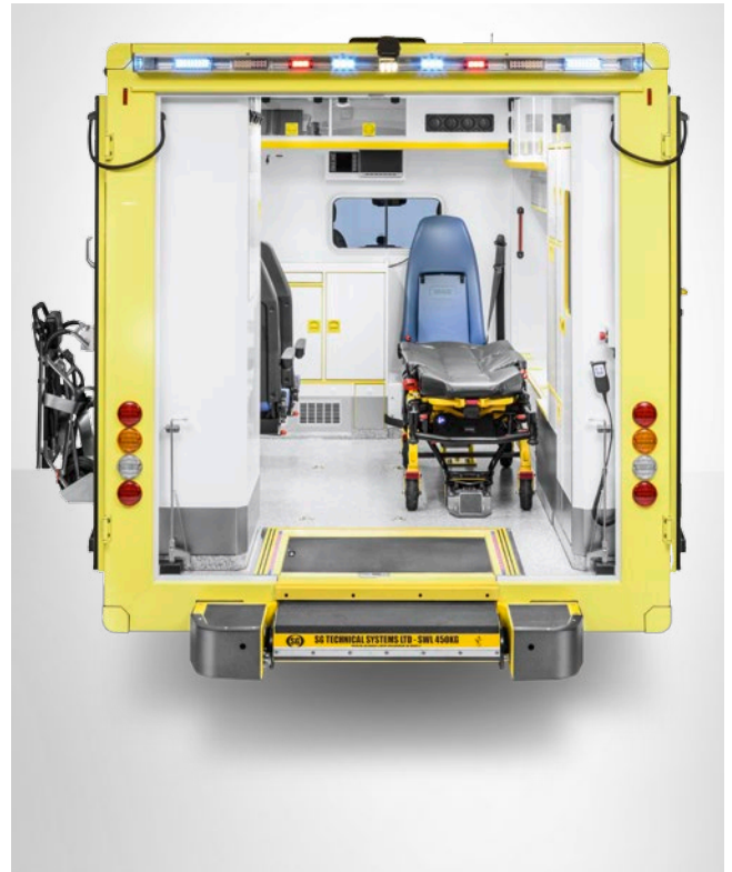
Die größere Innenbreite ermöglicht es, einen Tragestuhl zu verladen, ohne die Betreuersitze an die Seite drehen zu müssen.
