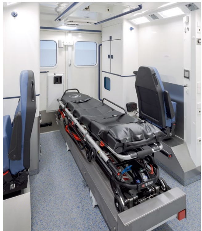
Zur optimalen Einrichtung des Innenraums während der Patientenbehandlung können die Sitze angeklappt und gedreht werden. Der Ambulanztisch mit der Fahrtrage kann aus seiner Mittelstellung nach rechts und links verschoben werden.
