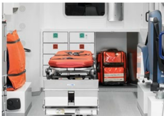
Ausbauvarianten: 1 Trennwandsitz, 1 Sitz an der rechten Seitenwand und 5 Schubladen, oder: 2 Sitze rechts und 8 Schubladen.
