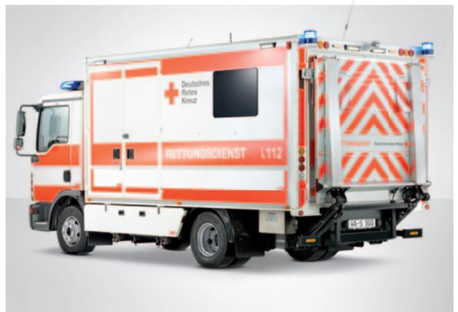
Das Großfahrzeug ist für viele verschiedene Einsatzbereiche geeignet. Mit einem zulässigen Gesamtgewicht von 7,49T kann es mit dem Führerschein Klasse C1 gefahren werden.
