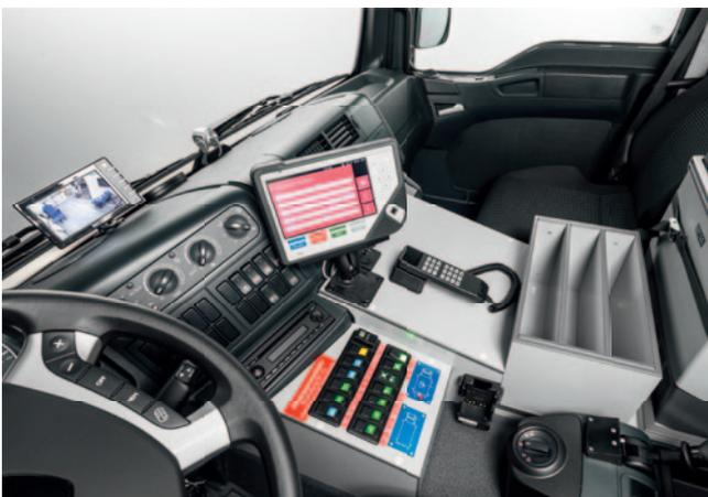
Die in die Fahrerkabine integrierte Mittelkonsole bietet viel Platz für die Kommunikationstechnik, Steuerung der Signalanlagen und ein Kühlfach.
