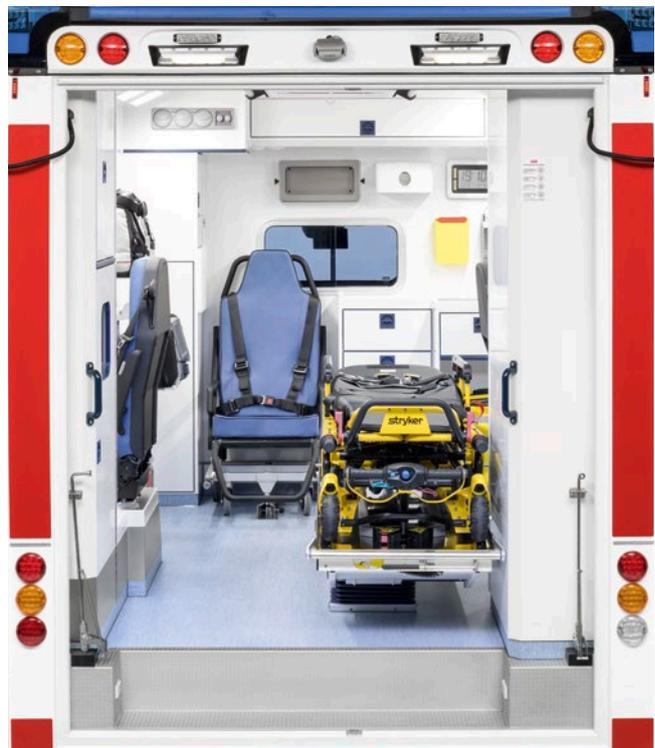
Der Ambulanztisch ist seitlich verschiebbar und der Tragestuhl kann bequem durch die Hecktüren be- und entladen werden.
