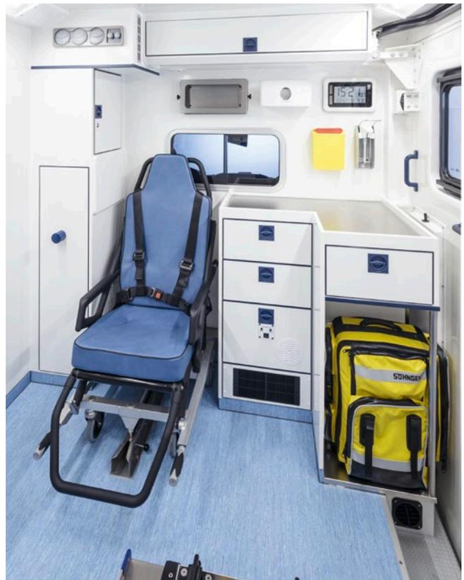
Durchdacht installierte Fächer und Schubladen sorgen für übersichtliche Aufbewahrung. Ein Patiententragestuhl ist mit Bodenschiene vor der Trennwand montiert.
