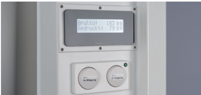
Eine Waage mit Tara-Funktion ermittelt das genaue Patientengewicht. Ein entsprechendes Wiegeprotokoll wird ausgedruckt.
