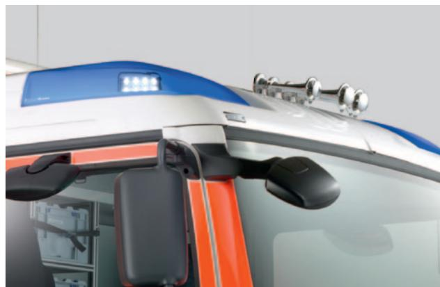
Die Warnanlage ist mit energiesparender LED-Technik ausgerüstet.
