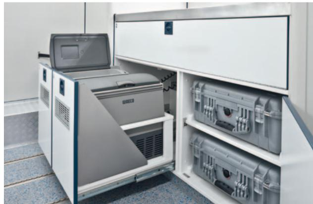
Im Frontgeschränk sind ein Kompressor-Kühlfach und ein Wärmefach integriert. Luftdicht verschlossene Koffersysteme schützen Ihre Ausrüstung.
