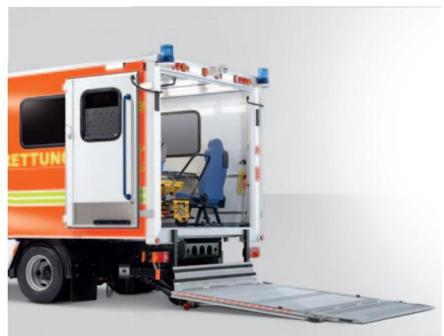
Die elektronische Beladerampe kann komplett auf Bodenniveau herabgefahren werden und erleichtert so die sichere Be- und Entladung des Fahrzeugs.
