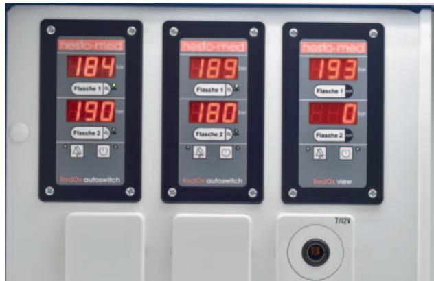
Übersicht auf einen Blick: Externe Anzeige und Bedieneinheit für Sauerstoff- und Druckgasflaschen.
