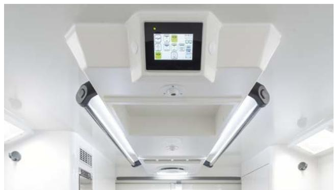
Das Deckcenter dient zur Aufnahme von Medizintechnik, Energie und Sauerstoffversorgung sowie des Touch-Bildschirms zur Steuerung des Ambulanztischs und der Heizungs-/Klimaanlage.
