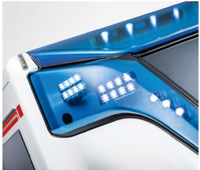
Die immer dichter werdende Geräuschdämmung moderner PKW führt dazu, dass Einsatzfahrzeuge zunehmend schlechter von Verkehrsteilnehmern wahrgenommen werden. Die neue integrierte WAS Design-Warnanlage sorgt für mehr Sichtbarkeit und somit Sicherheit.
