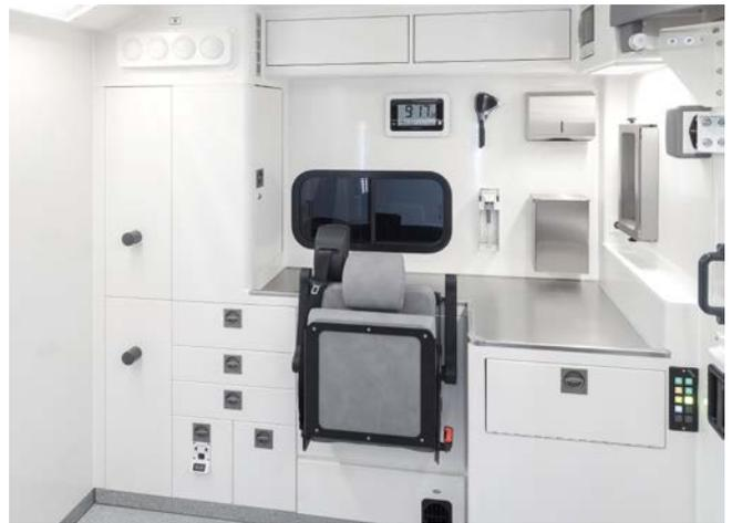
Mit den neuen Möbeln kann der Innenraum flexibel und kundenspezifisch gestaltet werden. Durch die besonders abgerundeten Außenkanten bieten sie mehr Sicherheit und Reinigungskomfort.
