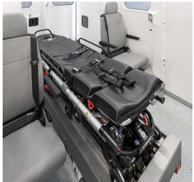
Die dreh- und klappbaren Betreuersitze mit Dreipunktgurten bieten maximale Sicherheit und sind aufgrund der nahtlosen Oberflächen einfach zu reinigen und zu desinfizieren.
