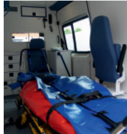
Auf dem rechten Radkasten befindet sich ein zweiter Arztsitz, unter dem eine Seilwinde für die Schwerlasttrage angebracht ist.
