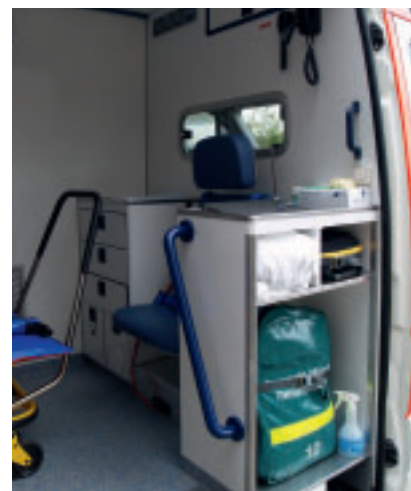
Besonders ergonomisch: Der Stauschrank für den Notfallrucksack ist von außen zugänglich. Er befindet sich an der rechten Fahrzeugseite und ist damit auf dem kürzestmöglichen Weg erreichbar.
