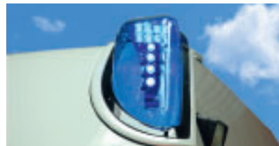
Durch LED-Blitzleuchten am Heck wird eine Rundumabsicherung des Fahrzeugs sichergestellt.
