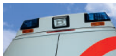
In die LED-Konsole am Fahrzeugheck ist zusätzlich ein Arbeitsscheinwerfer integriert.
