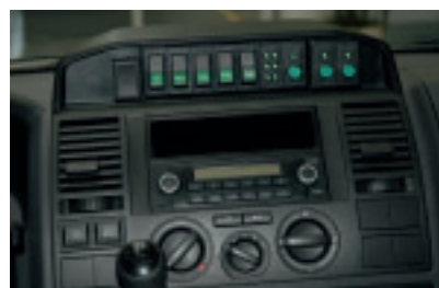
Die Bedieneinheit für die Wärmetechnik wird einfach auf das vorhandene Bedienelement aufgesetzt und ist farblich perfekt auf dieses abgestimmt.
